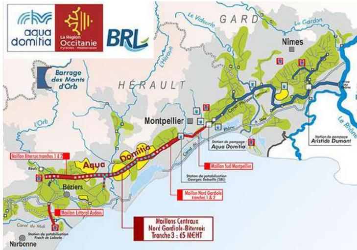
En parallèle, la **3ème tranche**, commune aux **Maillons Nord Gardiola et Biterrois** permettant le raccordement final ont été lancés en début d'été 2018. Ces travaux concernent la pose de **35 km** de canalisations en diamètre 1000 mm et 6 km en diamètre 800 à 500 mm, avec passage par tunnelier, sous l'Hérault, sous l'Orb et sous l'autoroute A75 ainsi que la réalisation de 3 stations de pompage devraient être achevés en 2021.
